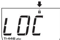
Para desbloquear, desligue o controlador e volte a ligá-lo com a tecla pressionada. Mantenha a tecla pressionada até que a mensagem apareça. Mantenha a tecla pressionada por 10 segundos e ao soltar a tecla, a mensagem será exibida no display, indicando o desbloqueio.
